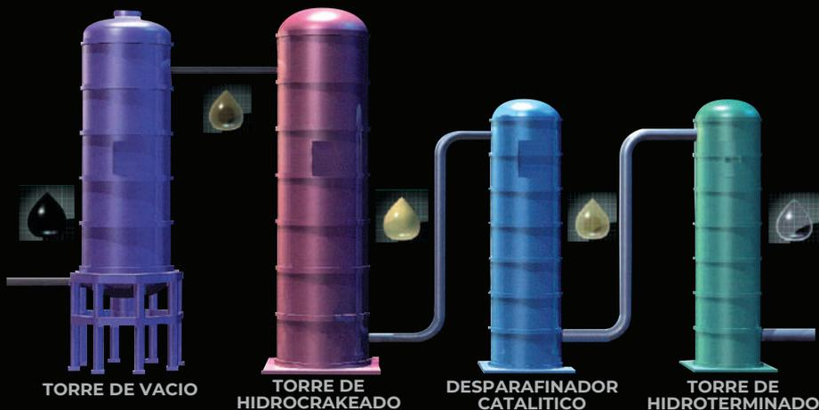
**HYDROCRACKEADO** es un proceso usado por Phillips 66 para mejorar la estructura molecular de la materia prima a un producto de color transparente, libre de aromáticos y azufre. **El HIDROCRACKEO produce lubricantes de alto rendimiento.**
